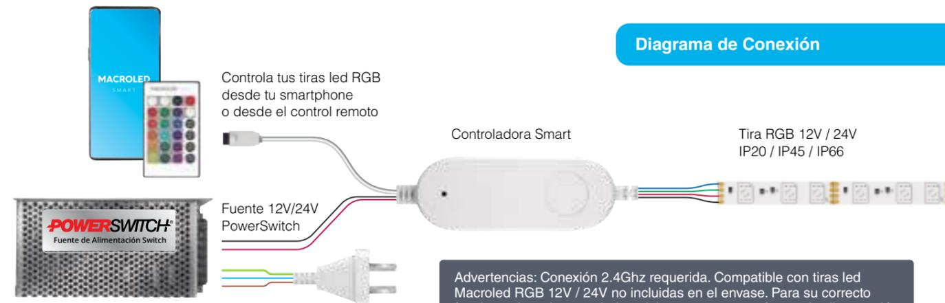
Advertencias: Conexión 2.4Ghz requerida. Compatible con tiras led Macroled RGB 12V / 24V no incluidas en el envase. Para su correcto funcionamiento la controladora debe contar con una fuente de alimentación PowerSwitch de 12V / 24V, no incluida en el envase.
